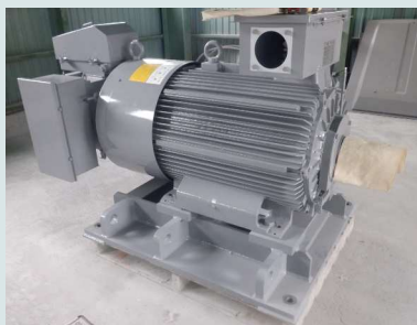
巻線型電動機更新 110KW 8P
