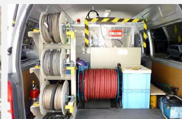
車載ケーブルユニット
