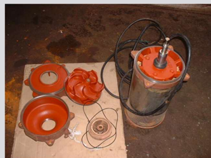
水中清水ポンプ分解整備
