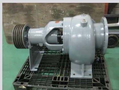
渦巻ポンプ分解整備
