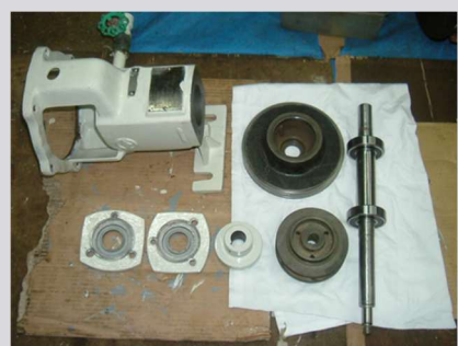
渦巻ポンプ分解整備
