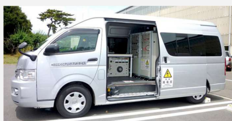
絶縁診断車(高圧用)
