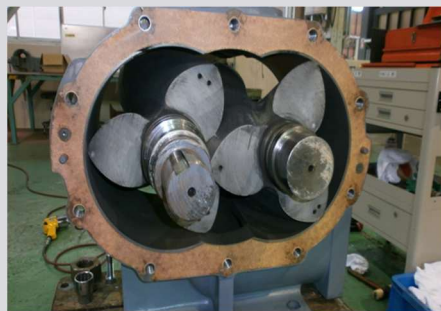
ロータリーブロワ分解整備
